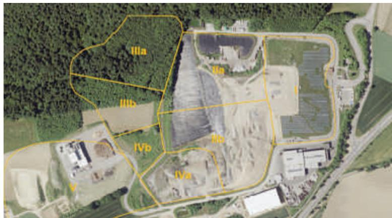
In die Deponie werden Erdaushub, Bauschutt, Straßenaufbruch, Holzasche, Gießereisande, asbesthaltige Abfälle, Mineralfaserabfälle, Schlämme aus der Wasseraufbereitung und ähnliche mineralische Abfälle eingebaut.
